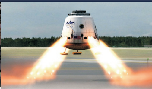
Ilustração mostra o inovador sistema de pouso da Dragon V2.
