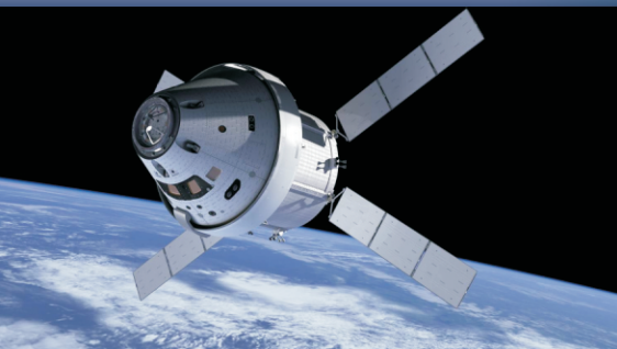
Órion acoplada ao módulo de serviço e painéis solares.
