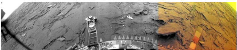
Figura 12. Venera 14 câmera 1. Nota-se o perfurador de solo sobre o protetor da lente.
