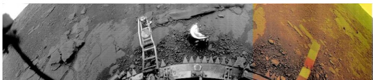
Figura 10. Venera 13 câmera 1. O protetor da lente está entre o analisador de solo e o calibrador de cor.
