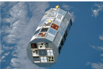
Long Duration Exposure Facility (LDEF), nave destinada a experimentos em microgravidade e testes em ambiente espacial.
