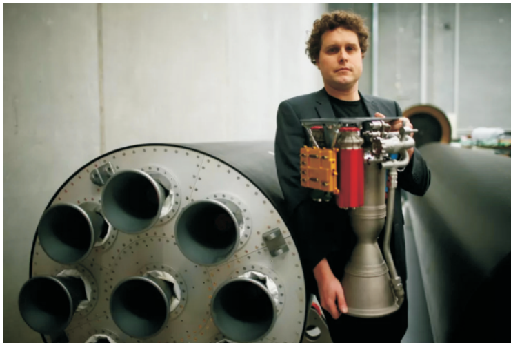
Imagem 6: o engenheiro Peter Beck, CEO da RocketLab, segura um motor Rutherford, fabricado com impressão 3D. Fonte: www.rocketlabusa.com
