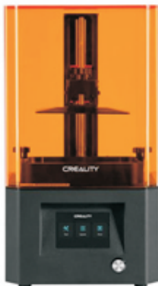
Imagem 3: A esquerda, uma impressora 3D de resina e na direita, uma peça sendo impressa.
