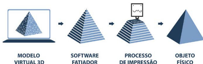
Imagem 2: Um resumo do processo da escolha de um modelo até a peça finalizada. Fonte: moust.com.br
