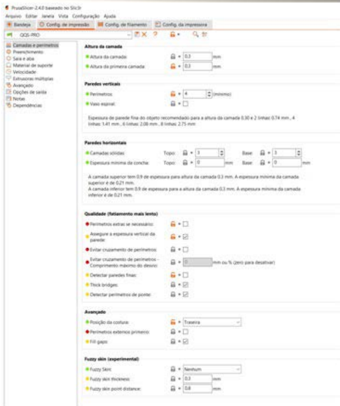
Imagem 3: Print da tela do Prusa Slicer mostrando as configurações de impressão relacionadas somente aos parâmetros da camada de impressão e perímetros.
