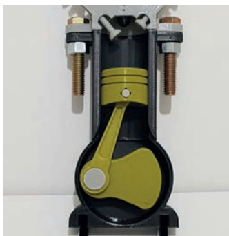
Imagem 4: Corte de um pistão de motor. Autoria Própria.
