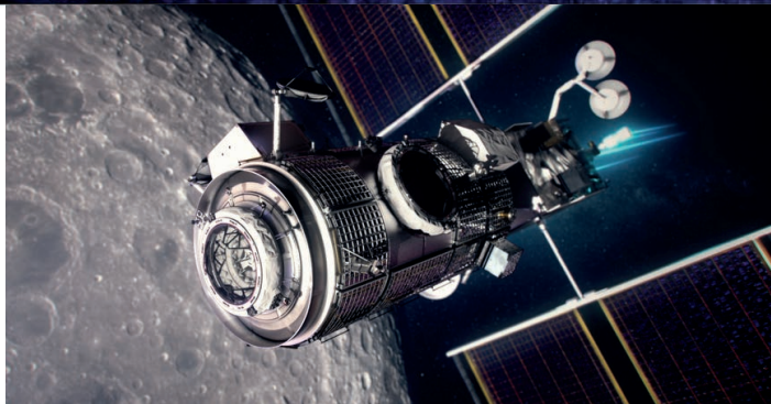
Configuração inicial da estação Gateway: módulos Halo (primeiro plano) e PPE.
