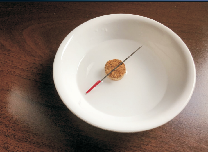
Vasilha com água e uma agulha imantada sobre uma rolha de cortiça. Fonte: Saskatchewan Science Centre.
