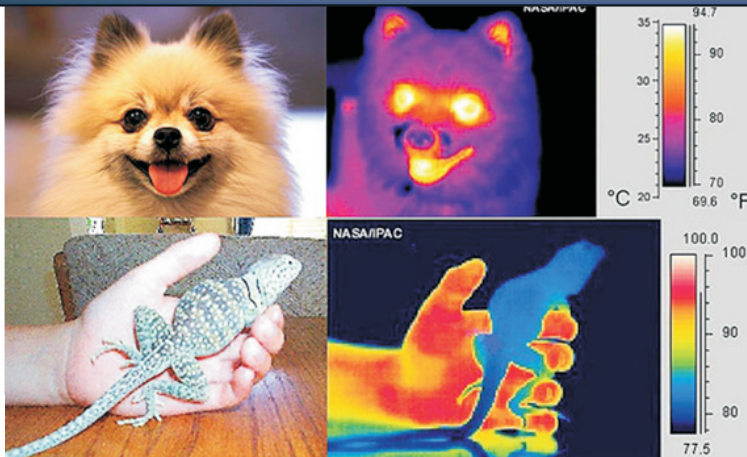
Imagem 4: Comparação entre fotografias normais (luz visível) e fotografias feitas no infravermelho. http://astrobob.areavoices.com/astrobob/images/IR_image_examples_NASA_2.jpg .
