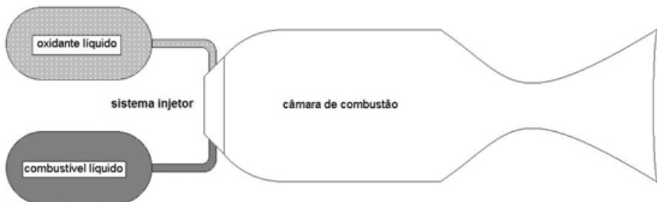
Esquema de um motor foguete a propelente líquido.
