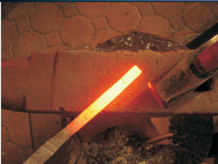
Luminosidade emitida pelo ferro em brasa na temperatura de 1200°C.
