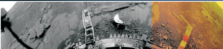
Figura 10. Venera 13 – câmera 1. O protetor da lente está entre o analisador de solo e o calibrador de cor.
