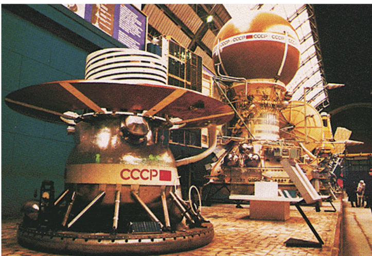
Figura 9. Sonda de pouso e orbitador ao fundo. Praticamente todas as missões Venera de 9 a 14 tinham seguido este padrão de naves. (Museu da Cosmonáutica - Moscou)
